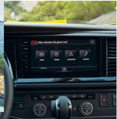
Sistema de navegación de 23,4 cm (9,2 pulgadas) "Discover Pro" (1) con reconocimiento de voz híbrido.
