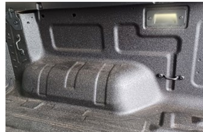
Iluminación LED en la zona de carga y seis anillas de amarre siempre de serie.
