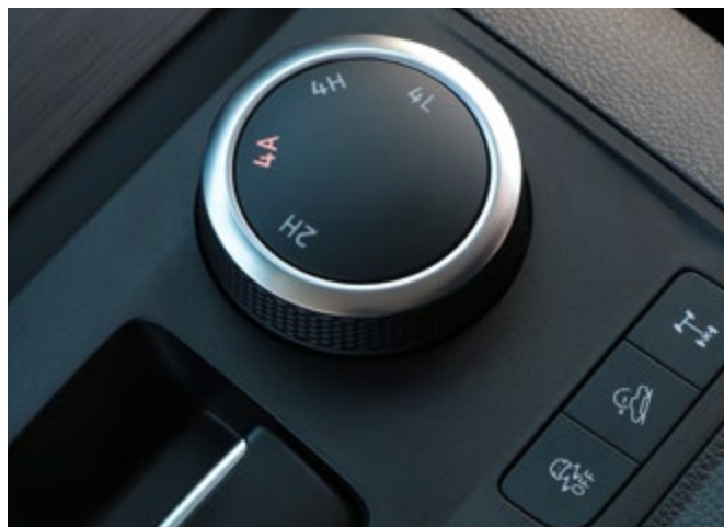
Conmutador de tracción integral conectable 4MOTION y botón de bloqueo del diferencial (derecha) en la consola central.
