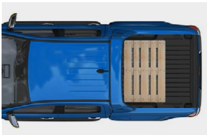
Zona de carga con tamaño adecuado para acomodar un europalé.
