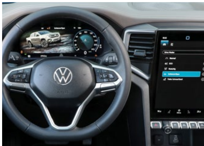
Visualización del modo de conducción “Mud/track” en la pantalla de infotainment y animación del modo de conducción en el panel de instrumentos digital.
