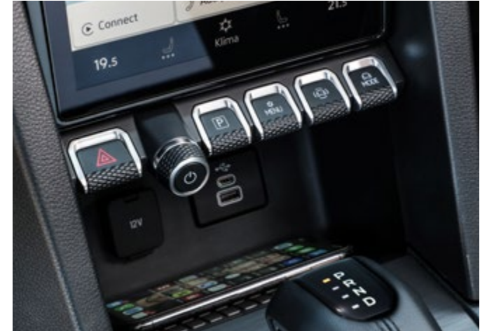
Botones de función, botón de encendido/apagado y control del volumen del sistema de infotainment (a partir del modelo Style con entorno cromado), toma de corriente de 120 voltios, interfaz USB-A y USB-C, y compartimento para móviles (a partir del modelo Style, con función de carga inductiva, opcional en los demás modelos) en el compartimento de almacenamiento debajo de la pantalla táctil a color.
