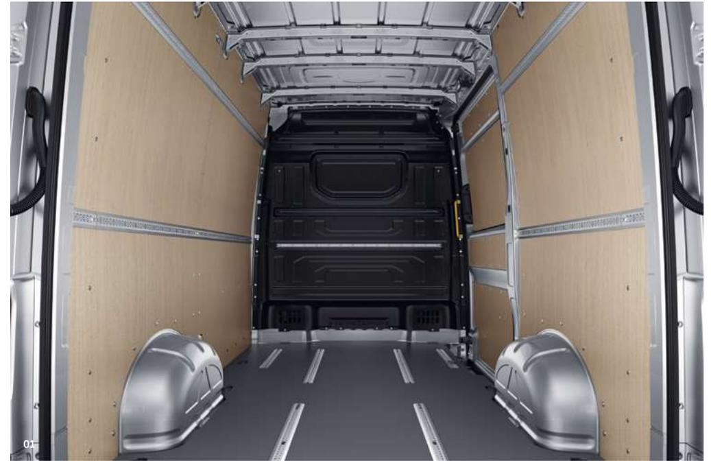
**01 Suelo de madera.**<sup>1), 2)</sup> El robusto suelo de madera de 8 mm en el compartimento de carga conforma la superficie óptima para su carga. La robusta madera de haya garantiza una estabilidad y durabilidad excelentes. |FU|
