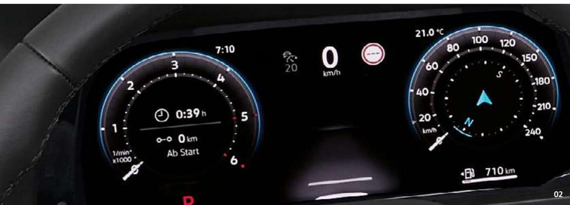
**02 Pantalla multifunción "Plus".** La pantalla TFT monocroma muestra información actual, como la temperatura exterior, la autonomía restante, la velocidad media y el consumo promedio. Facilita además un uso cómodo de los sistemas de asistencia al conductor y un control rápido de las funciones del vehículo. | FU |
