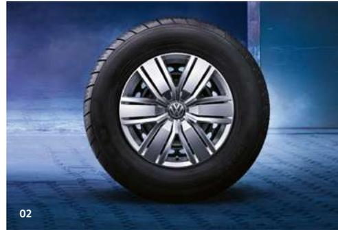
02 Llanta de acero 6 ½ J x 16 con carga de 1050 kg, en negro. Con neumático 235/65 R 16 | FU |
