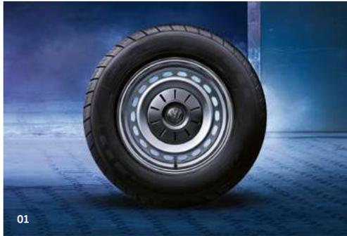
01 Llanta de acero 6 ½ J x 16 con carga de 1050 kg, en plata. Con neumático 235/65 R 16. | FU |
