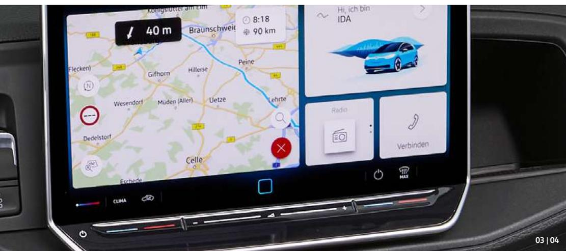
**03 Sistema de radio "Composition Media".** El sistema está compuesto por una pantalla táctil a color de 26 cm (10"), 4 altavoces, 2 puertos USB tipo C y conexión bluetooth con función de carga inalámbrica. | FU |
