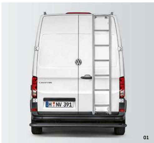
**01 Escalera en la puerta de dos hojas.** Ofrece un acceso rápido a la carga y descarga del techo. Gracias a la sujeción directa de la escalera en la puerta de dos hojas, se logra una apertura sin obstáculos. | FU |
