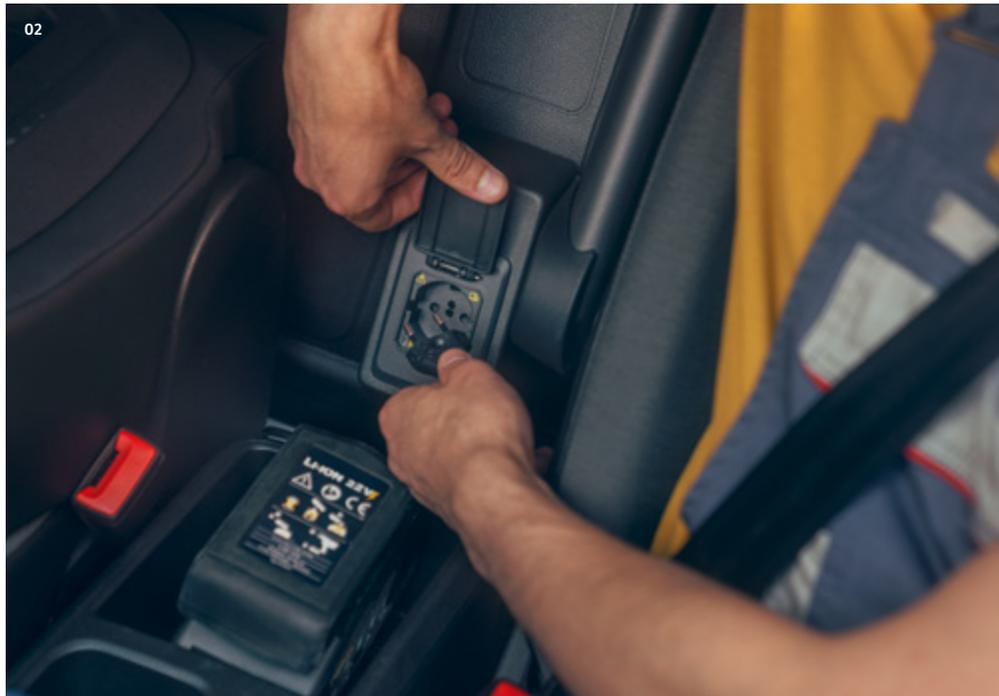
**02 Enchufe de 230 V.\*** Cubre las necesidades de energía más exigentes. La posición central en la pared separadora es ideal para cargar distintos dispositivos, como portátiles y herramientas, en la cabina del conductor.
