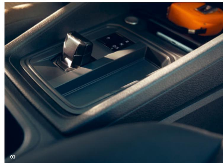
**01 Caja de cambios de doble embrague DSG.**<sup>1) 2)</sup> El Caddy Cargo puede equiparse con un cambio de marchas totalmente automático sin interrupción de la tracción con un DSG de 7 velocidades.
