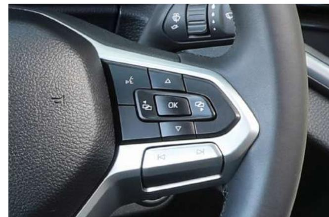
Botones de control para el panel de instrumentos digital a la derecha del volante multifuncional (la ilustración muestra la línea de equipamiento Aventura).
