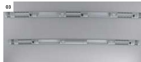
**Parabrisas térmico.** Asegura una buena visibilidad incluso en tiempo frío y húmedo. Los elementos de calefacción están integrados en la ventanilla.
