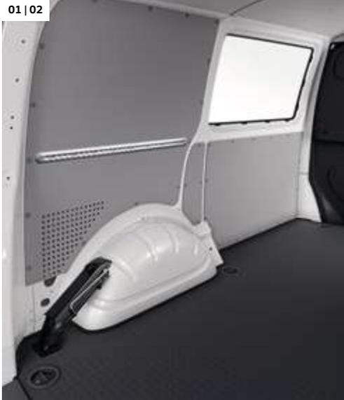
**01 Revestimiento lateral alto (tableros aglomerados).**<sup>1)</sup> Protección de los paneles laterales desde el suelo hasta la estructura del techo.
