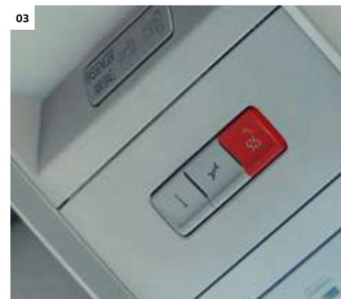
**03 eCall.** Tras un accidente, el sistema transmite automáticamente la hora, la posición del vehículo y el número de ocupantes al centro de llamadas de emergencia y establece una conexión de voz. El sistema se activa mediante un sensor de colisión o manualmente a través del botón de llamada de emergencia. Disponible con el sistema de radio "Composition Colour" y superiores. | F | MP | KO | M | CH |
