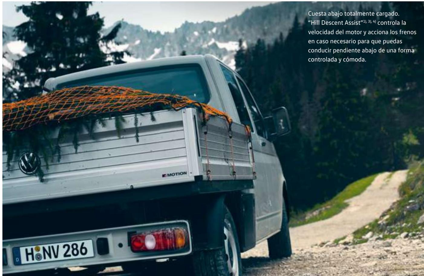
Cuesta abajo totalmente cargado. "Hill Descent Assist"<sup>(1), 3), 4)</sup> controla la velocidad del motor y acciona los frenos en caso necesario para que puedas conducir pendiente abajo de una forma controlada y cómoda.
