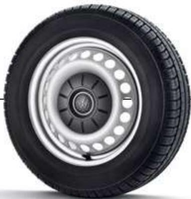
**Llanta de acero con tapacubos central<sup>1)</sup>**
