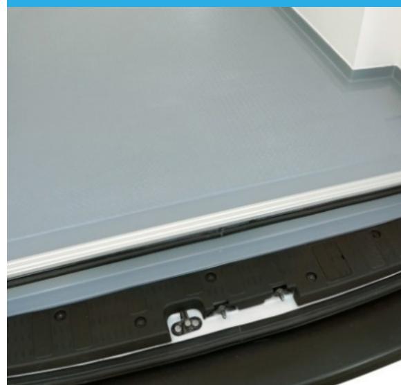
Protecciones de aluminio y doble juego de juntas de goma perimetrales en puertas traseras y lateral.
