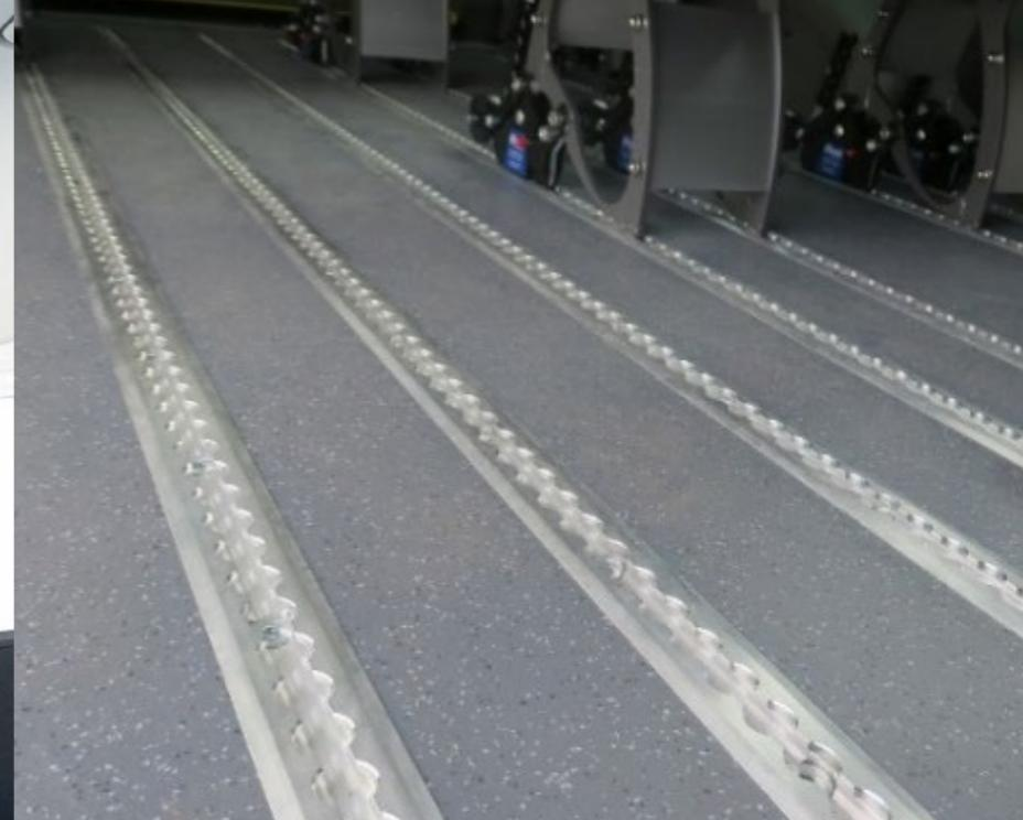
Suelo de aluminio con tapizado de alta resistencia y fácil limpieza. Incorpora 8 guías para la distribución de asientos y anclajes para las sillas de ruedas.
