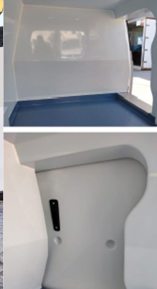
Acceso a manetas cerraduras originales
