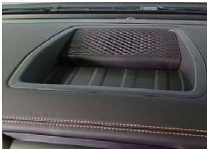
Safata d'emmagatzematge al centre del quadre d'instruments.
